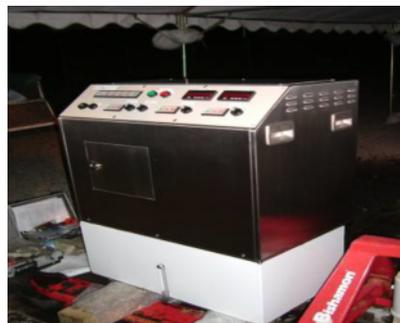
エマルジョン燃料製造装置試作機
