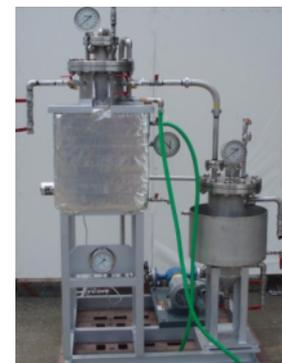
亜臨界水処理装置 試作機
