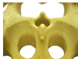
B：HSB 中子 低温造型につき レジンの劣化がない ため鋳肌がきれい
