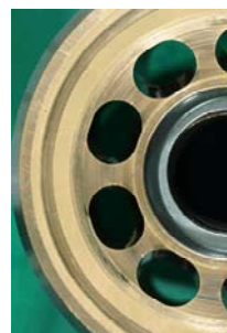
図 2 開発合金によりバイメタル化したピストンポンプと開発した分析標準物質
