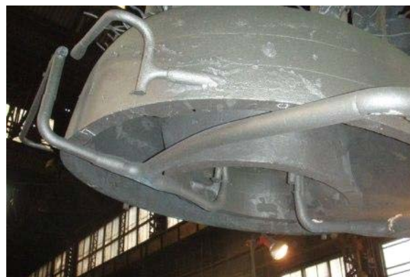
図 2 実用化試験により製造した 2.6t ベルマウス
