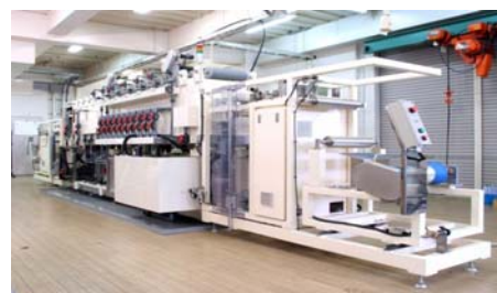
図3 不溶性陽極採用の2層CCL用連続銅めっき装置
