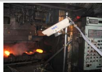
サーモビューアによる鍛造金型の表面温度測定風景
