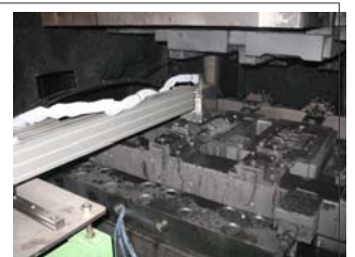
レーザースキャナによる鍛造金型の形状測定風景
