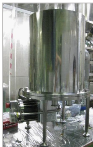
冷凍機冷却型超電導電磁石の外観
