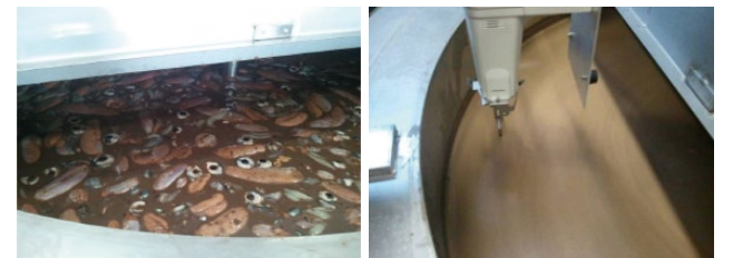
溶解槽に投入したイカゴロ(左)とスラリー状のイカゴロ(右)
