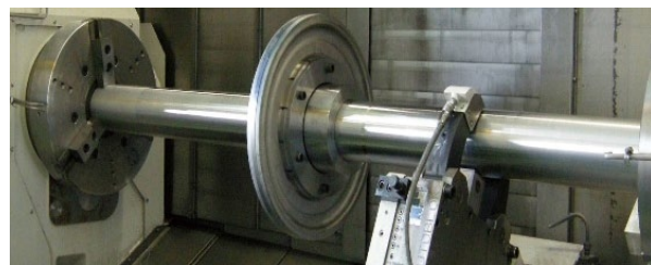
複合5軸加工機にディスク形状のワークを内張り串刺し状態でセットし、1チャックで総ての工程を行う
