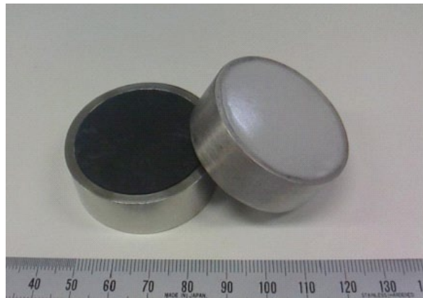
写真 SMAリングで補強されたバルク体 (左：樹脂コート無し、右：樹脂コート有り)
