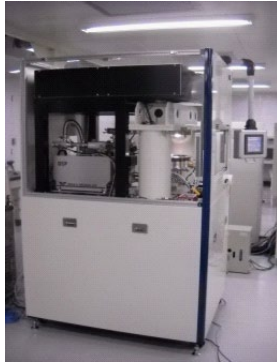
レーザスキャン、真空プレスおよびレーザ照射を統合した熱ナノインプリント装置外観
