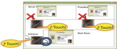
WiPoTシステムを利用したIDカード兼入退出管理システム
