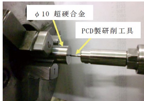
超合金製絞り金型の加工に使用した装置の外観
