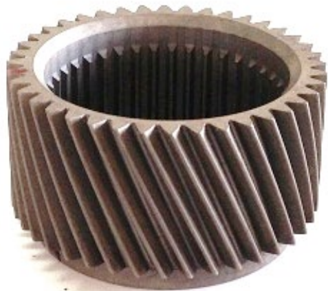
開発した冷間鍛造ヘリカルギヤ
