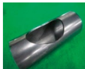
パイプ側面3次元切断品
