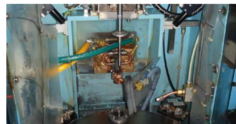
FA化高周波焼入れラインの一部
