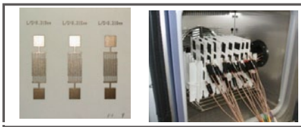
櫛形電極を用いたイオンマイグレーション試験
