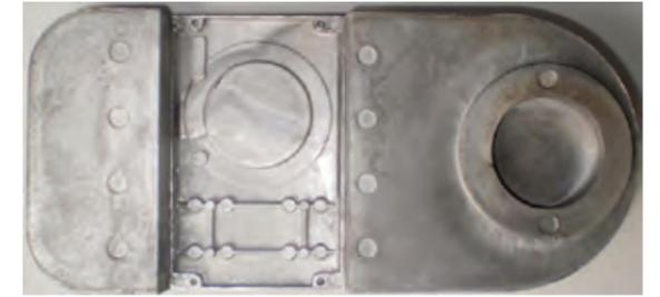
デジカメ筐体の成型品の引張り試験結果(材質:A6063、JIS14A号試験片) ~引張り強さは101.7MPa、0.2%耐力47.7MPa、伸び8.4%(0.2%耐力は熱処理を行っていない6063材と同等であり、目標達成と判断)～
