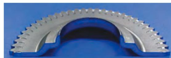
10,000kN多軸精密制御プレス機による
