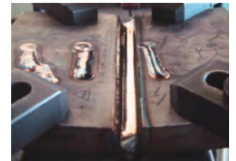
斜面での溶接は、重力の影響を受け、溶接ビードが団子状になってしまうが、溶接条件の調整により、安定した良好なビード状態を実現(X線透過試験により、ブローホール等の欠陥がないことを確認)
