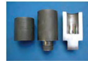
前方軸・後方軸複合押し鍛造加工
