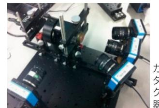
カメラ・プロジェクター活用でのコネクタピン位置指示器実験モデル
