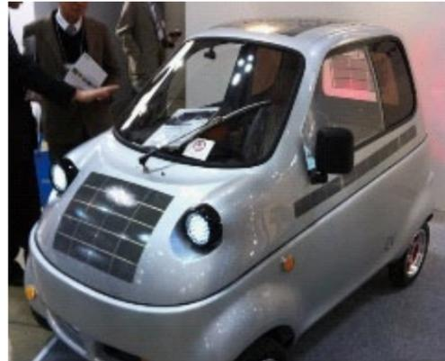
小型電気自動車FRPボディへの一体成型例
