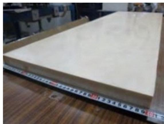
簡易の大型模型金型
