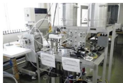
酵素精製装置のパイロットモデル
