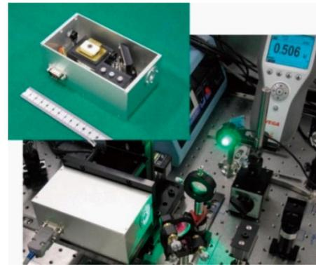
波長変換ユニットとピコ秒グリーンレーザー発振の様子
