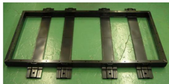
鉄とアルミの異材溶接技術を用いたバッテリークロスメンバ
