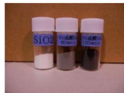
SiO<sub>2</sub>への成膜時間に伴う外観変化
