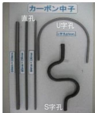
超細鑄抜き孔(S字とU字形状孔)
