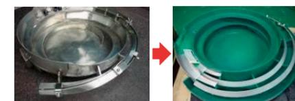
パーツフィーダーへのポリウレタン皮膜の施工例
