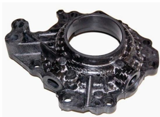
熱可塑性CFRP製の試作品
