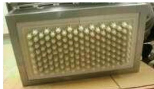
実製品寸法の真空成形用金型
