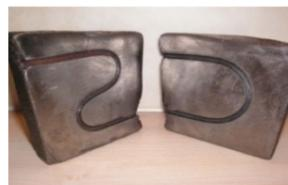
超細鑄抜き孔(S字とU字形状孔)
