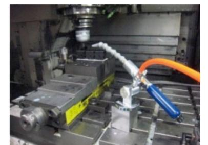
冷凍チャック・スポットクーラーを使用している加工
