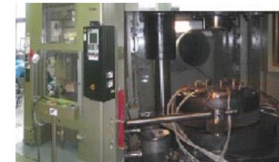
加熱した金型を搭載した630tサーボプレス
