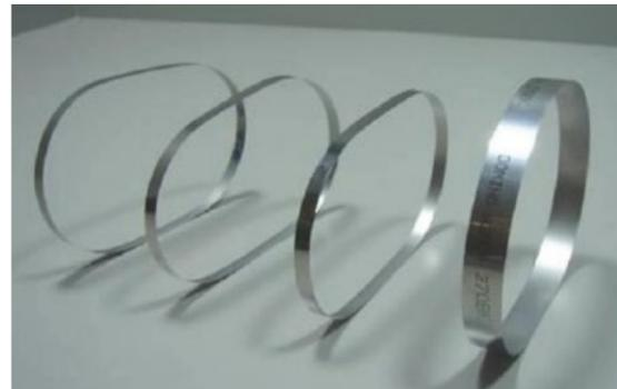
動力伝達用ステンレス鋼製シームレスベルト
