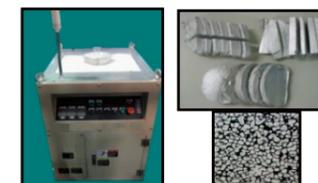
半凝固生成に欠かせない電磁攪拌装置及び半凝固スラリー・金属組織画像
