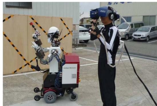
FSTによるロボット遠隔操縦の様子
