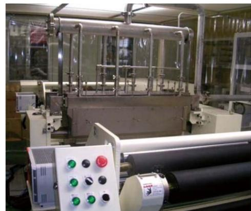
ロールtoロール式フッ素ガス表面処理システム
