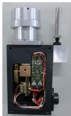
測長タッチセンサ内部の構造
