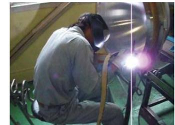
2重シールドティグ溶接トーチによる溶接
