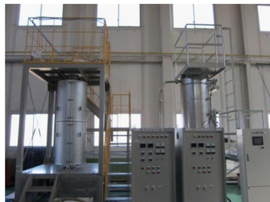
正極材料製造装置
