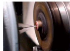
外径0.5mmの砥石による超音波電解内面研削
