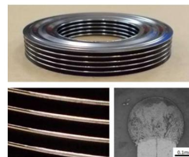
難溶接材ペロースと溶接部拡大とその断面
