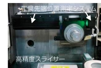
高精度スライサーへ工具先端位置測定システムの設置
