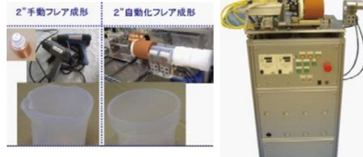
2インチチューブ径対応フレア化試作自動化装置
