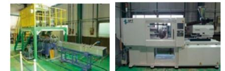
(左)二軸混練押出機、(右)射出成形機
