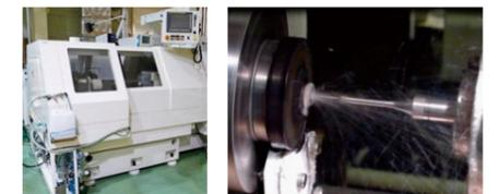
超音波電解内面研削盤 通液型超音波スピンドル
