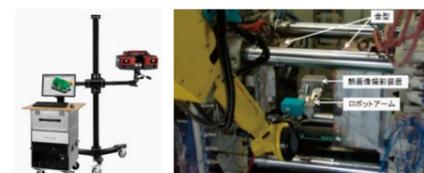
高精度な金型の形状及び温度計測
