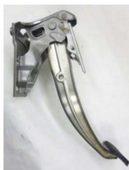
鉄とアルミの異材溶接技術を用いたブレーキペダル
