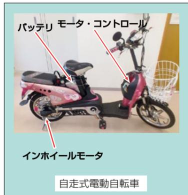
本開発技術を適用した自走式電動自転車の外観
