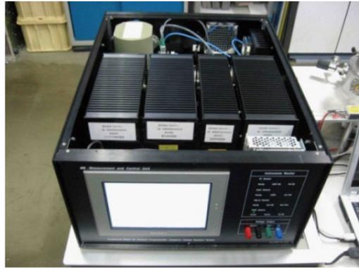
小型汎用ジョセフソン電圧標準装置
