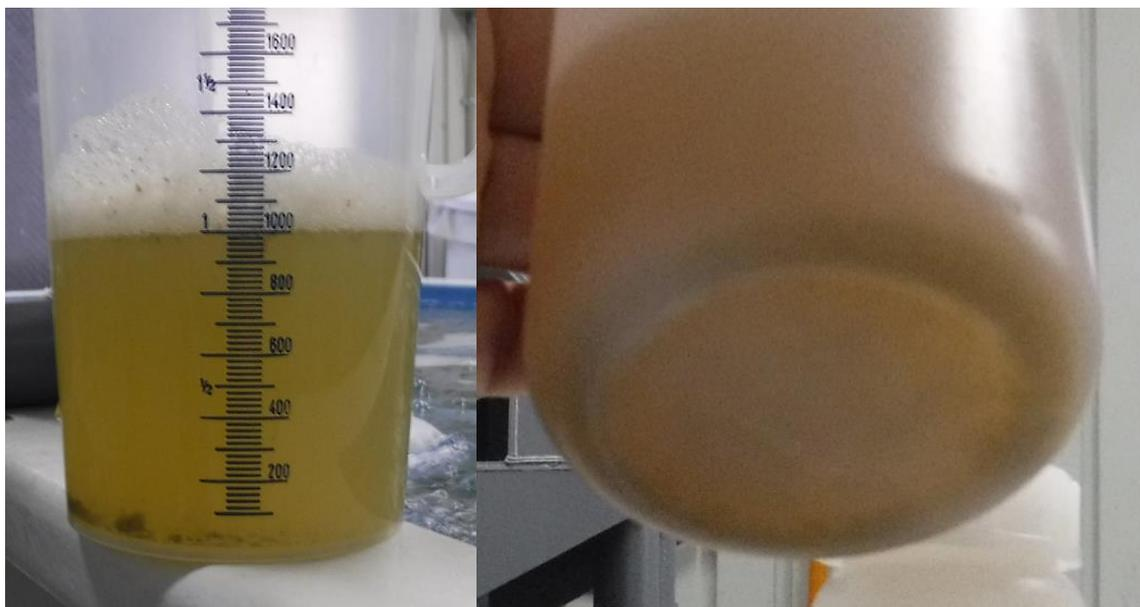
泡沫分離機により回収した代謝物液（左）と柿渋タンニン添加後に確認された沈殿（右）
