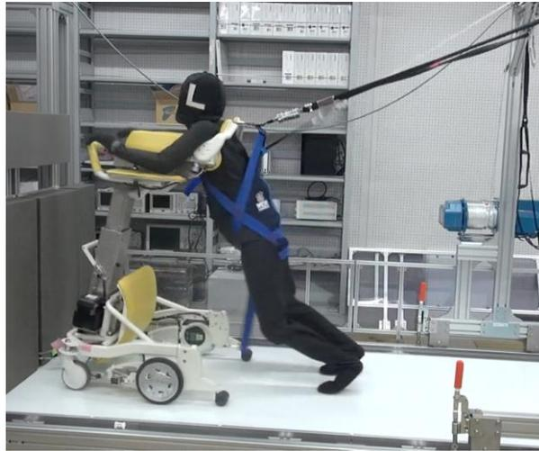
図 20. 動的安定性試験
