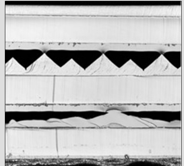
プリズムシートと拡散シート3枚構成の断面図
