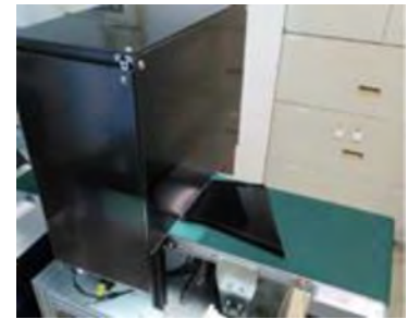
図12. 光沢面の外観検査システムイメージ例
