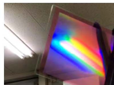
図2. 開発に成功したホログラフィック光学素子（HOE）
