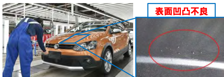
図1. 光沢表面（自動車ボデー）の目視での外観検査
