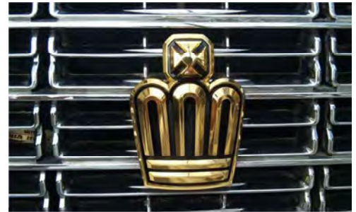
図31. 凸面と凹面が混在する形状（複雑R形状）の例
