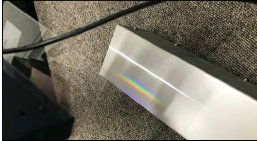
図39. LEDライン照明を用いたHOE光源からのパターン照射実験結果
