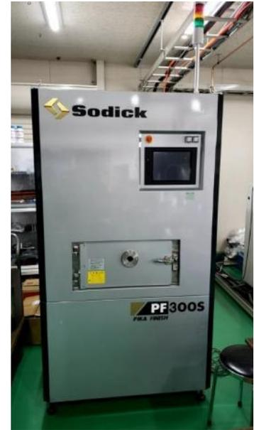
図 2-1 電子ビーム照射装置
