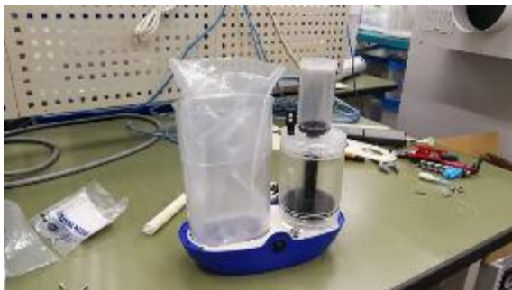
図 22 輸液ポンプケースの底部分に真空加圧シリンダーと加圧容器を設置する状
