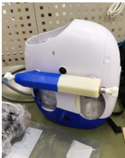
図 23 空気入れが輸液ポンプケースに設置できる
