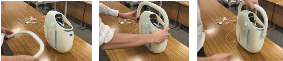
図 31 手持ち用の取っ手と輸液ポンプケースの取付けに、マグネット治具を使用している。
