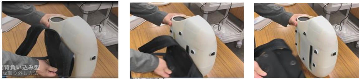
図 30 背あてと輸液ポンプケースの取り付けも、同様のマグネット治具により容易に行うことができる。
