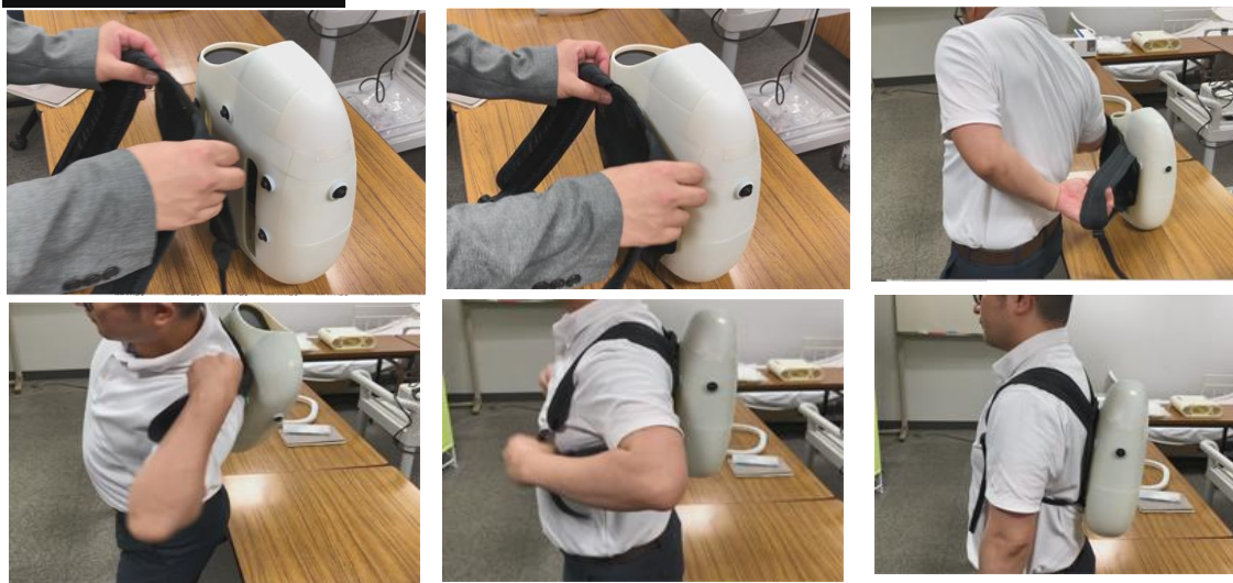
図 29 介護者・介助者が容易に扱えるマグネット治具により、背あてを取り付け、背負える機構にした。
