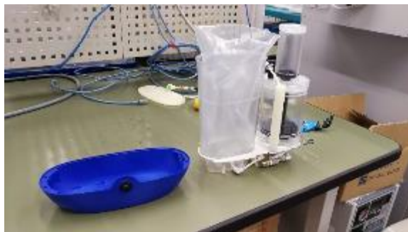
図 22 輸液ポンプケースの底部分に真空加圧シリンダーと加圧容器を設置する状
