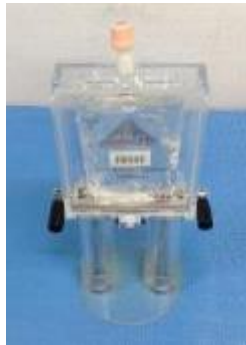
〔4-1〕 リセット機構 : 手動レバーまたはエアリフター（蛇腹ジャッキ）
