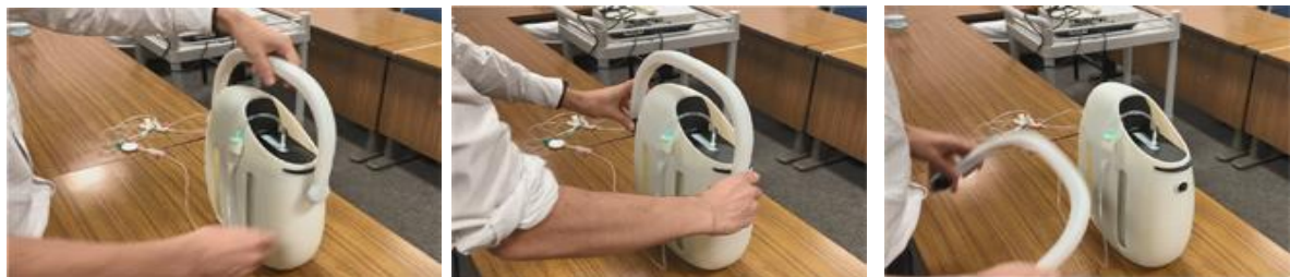
図 32 取っ手と輸液バッグケース本体の取り外しも、ワンタッチで容易に行うことができる
