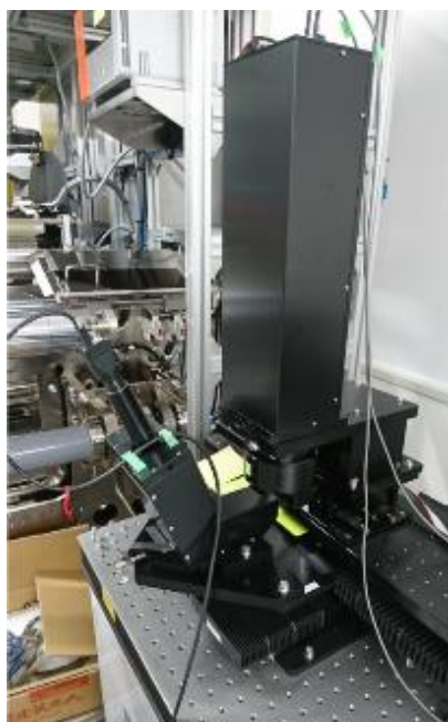
図2-3 精密光学調整装置を用いた光学調整： (左)調整実験外観、(右)レーザー光の可視化像
