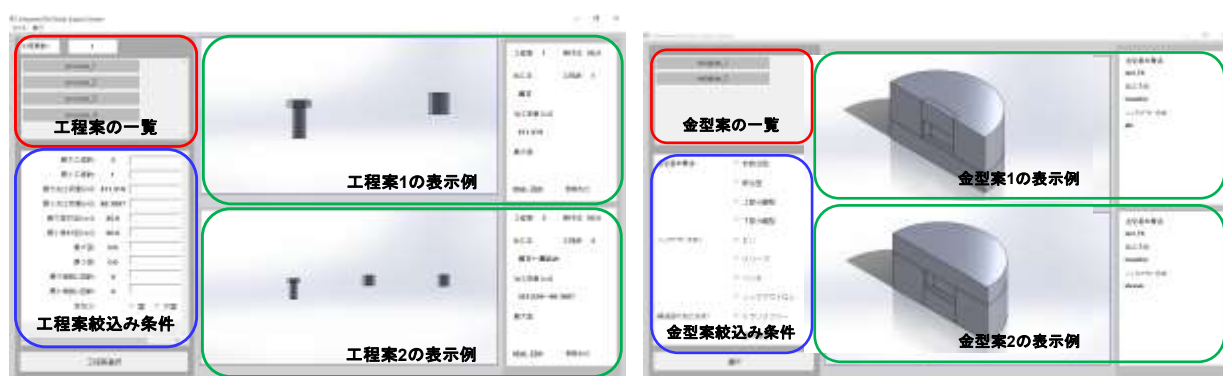
図 3-8 鍛造工程・鍛造金型統合設計システムの実行画面の例
