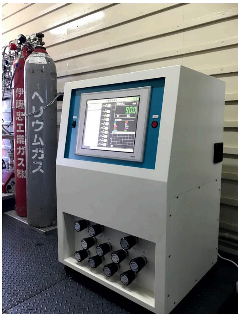
写真1：10種ガス混合装置
