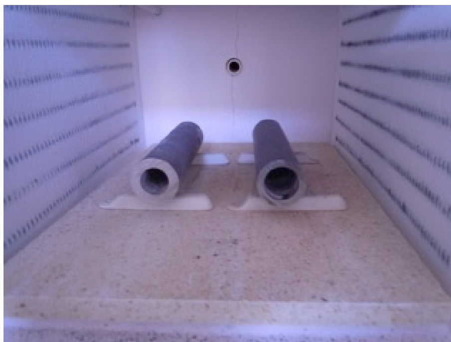
図5 高温耐熱性試験
