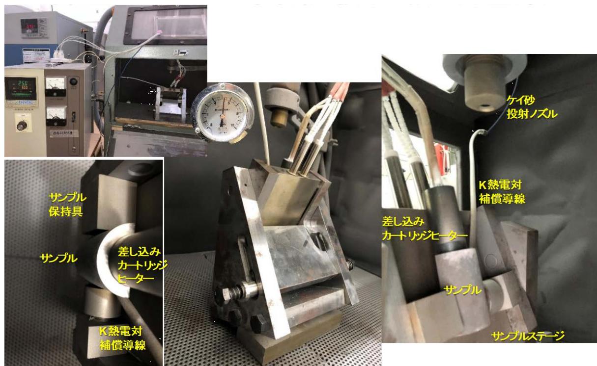
図6 高温耐摩耗性試験装置
