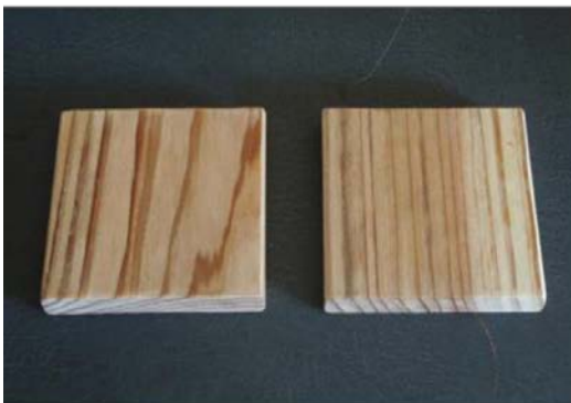
図9 内装用不燃木材試験ピース
