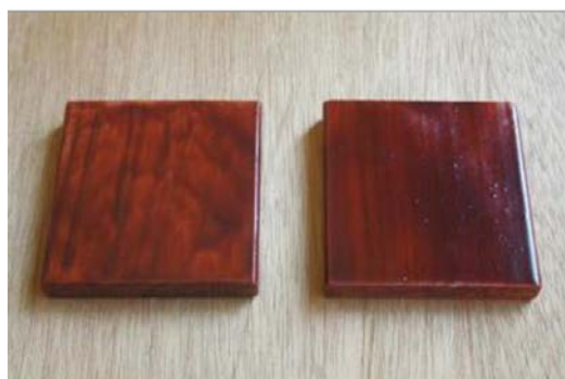
図 11 外装用不燃木材試験ピース
