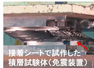
接着シートで試作した積層試験体(免震装置)の性能評価
