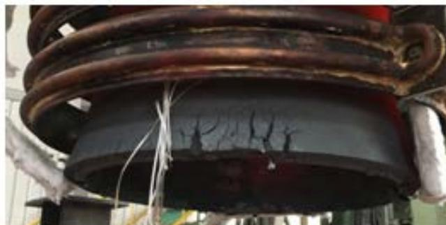
図9 スリーブのき裂
