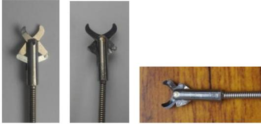
図 2-3-3 鉗子剪刃先端の試作
