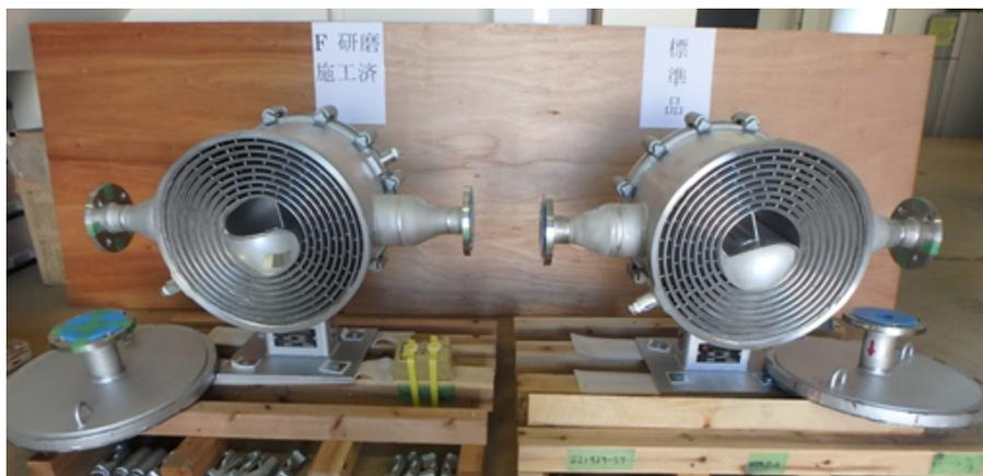
図4-1-10 【スパイラル式】熱交換器
