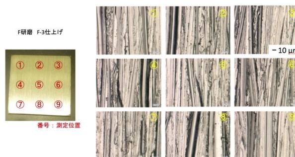
図 1-2-3 F-3 研磨プレート凹凸分布
