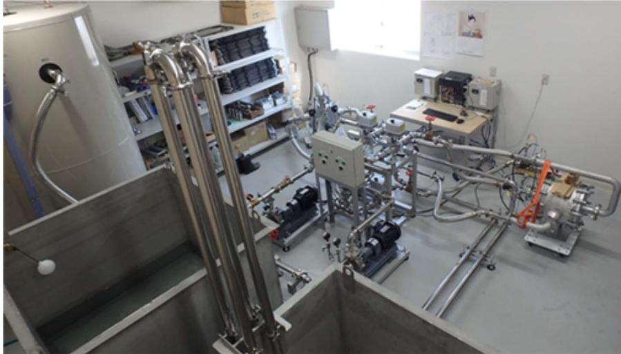
図4-1-9 【スパイラル式】実証実験装置
