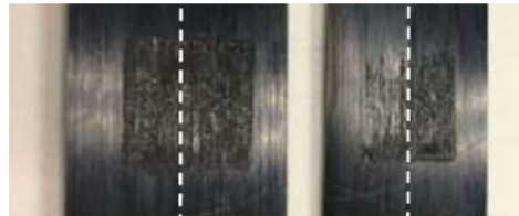
図 2.2.6:加熱バー方式による UD テープ溶着の様子
