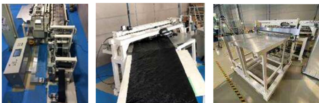
図 2.2.10: 任意配向接合装置(左: UD テープ供給・切断部, 中: 接合部分及び接合シート, 右: シート切断部)
