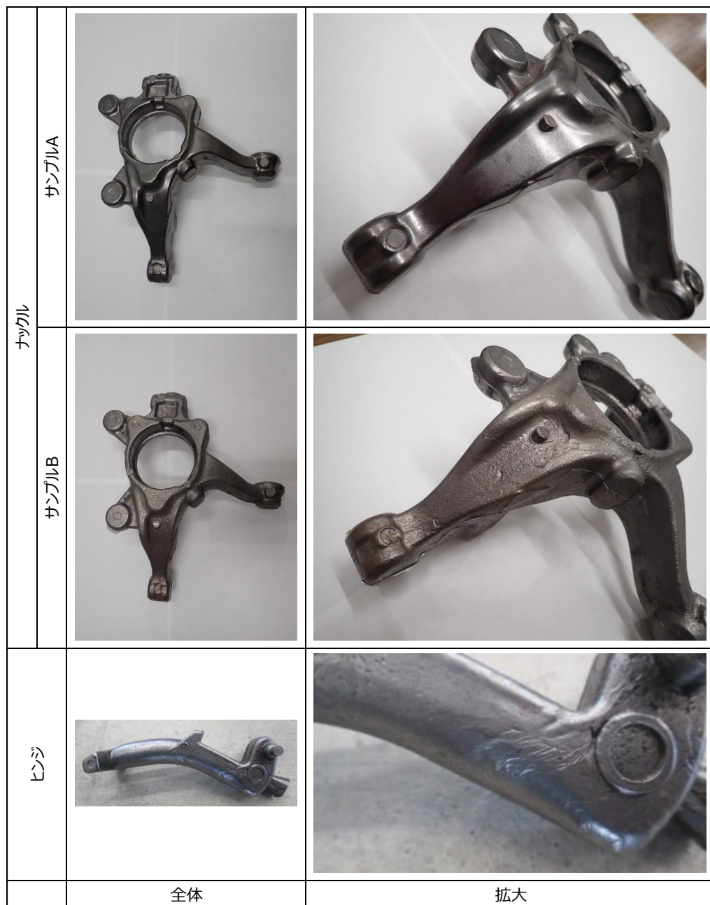
図 1 0 本研究での金型 casting 品外観
