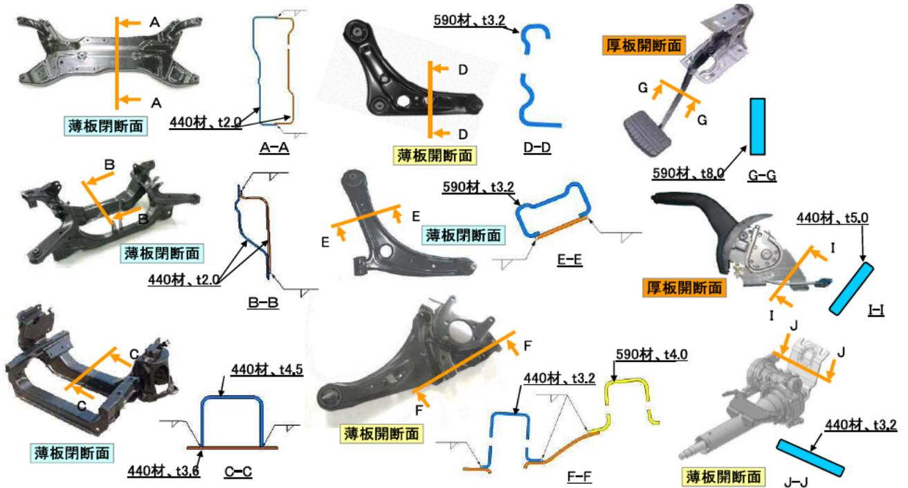
図1. サスペンション部品と操作系部品（板金プレス加工部品）
