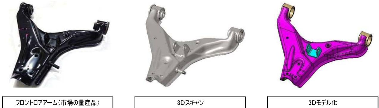
図8.3. フロントロアアーム 3Dモデル化検討
