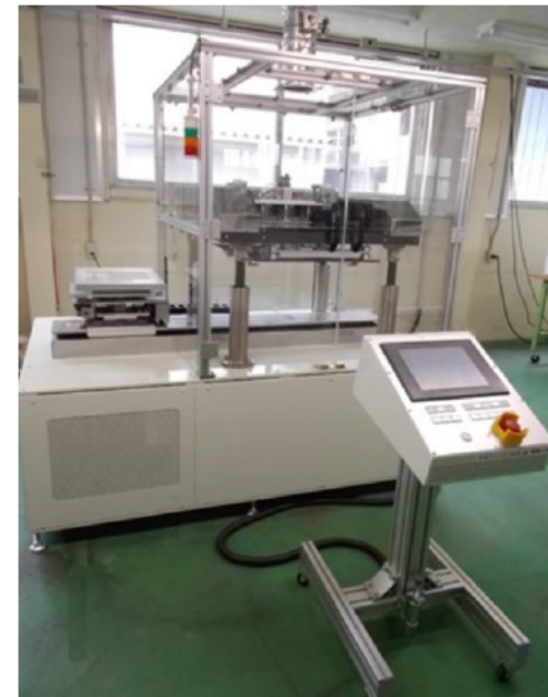
印刷方式:スクリーン印刷、メタルマスク印刷 ワークサイズ:最大W250mm×L250mm
