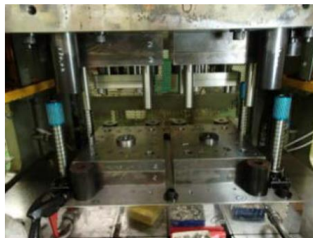
図 2-2-3 試作した 1 ショット 2 個取り金型
