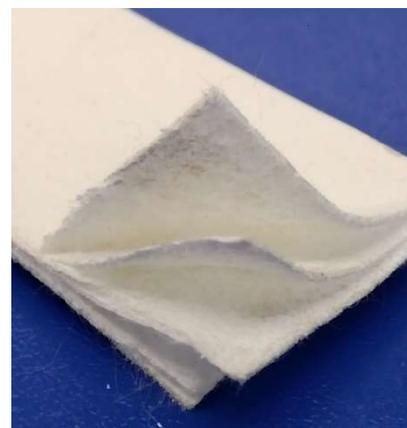
プレス積層した冷却シート（不織布積層板）
