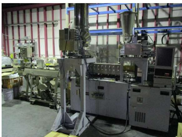
導入した二軸押出機
