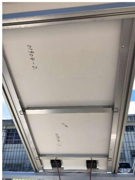
図5-9. 太陽電池裏面に張り付けた冷却シートの外観。貼り付けには株式会社パワーバンクが作製した治具を使用した。
