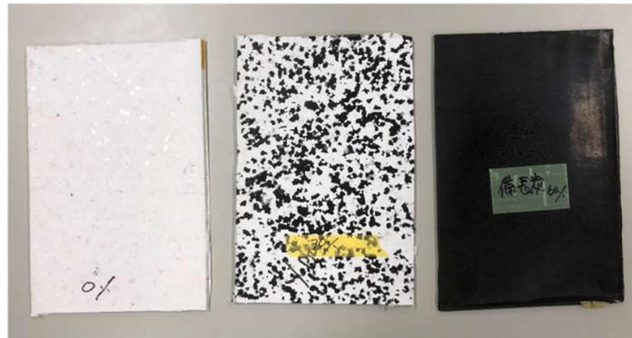
図5-6. マスターバッチ冷却シートの外観
