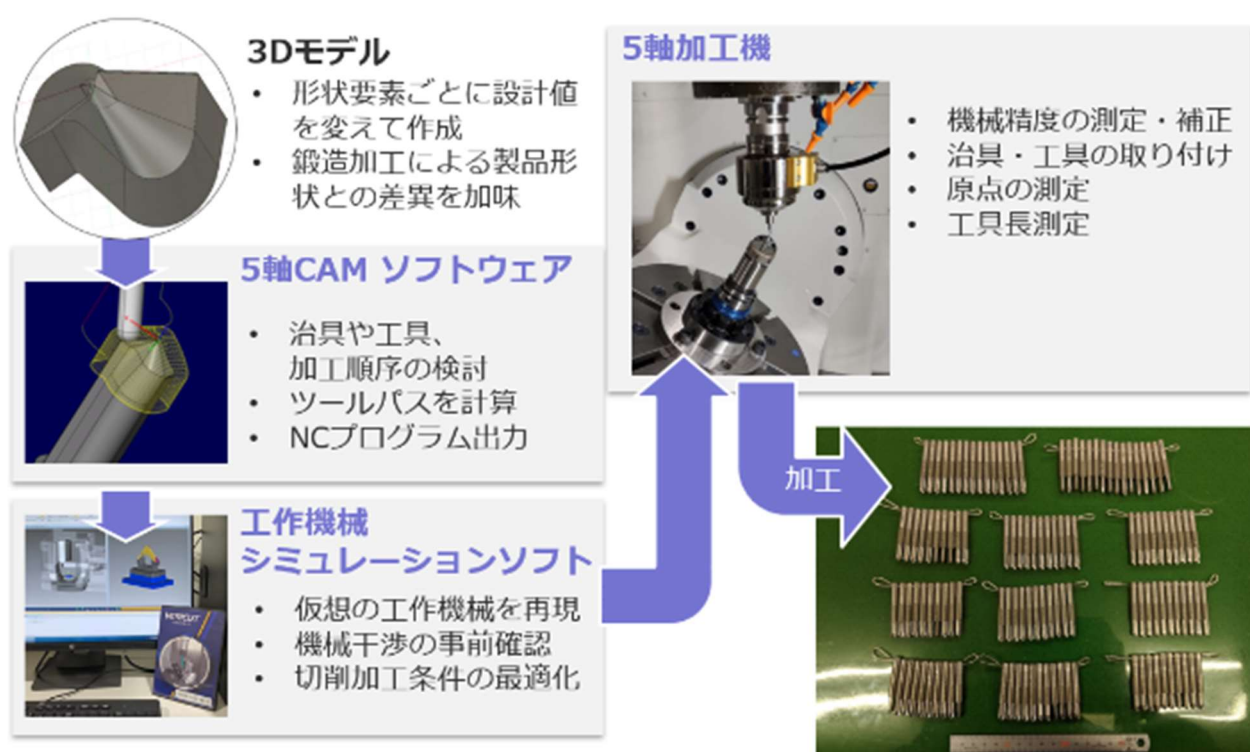
図 11 5 軸加工機による試作加工工程
