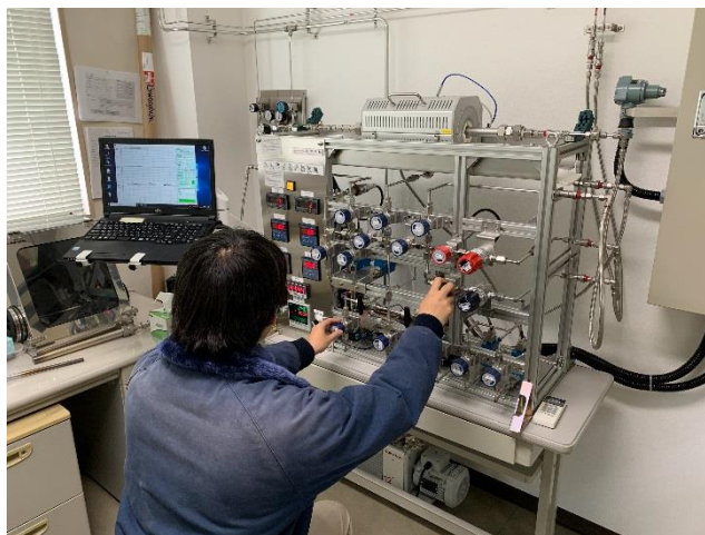
図 2-3-4 水素透過装置で測定する様子
