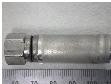
図 2-3-2 試作した円筒状水素透過ユニット （溶射皮膜および Pd 形成後）
