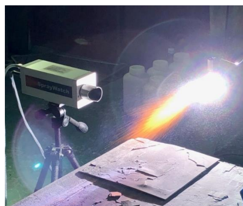
図 2-2-5 スプレーウォッチにて溶射粒子を計測する様子
