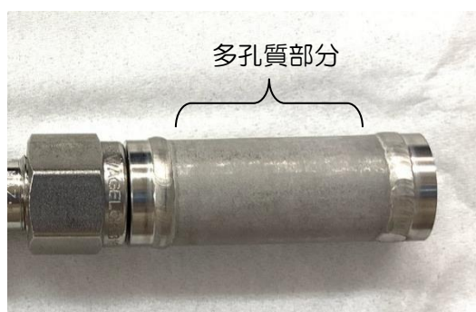
図 2-3-1 円筒状ステンレス多孔質体 （溶射前）
