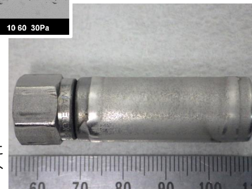
溶射皮膜を用いた 水素透過ユニット
