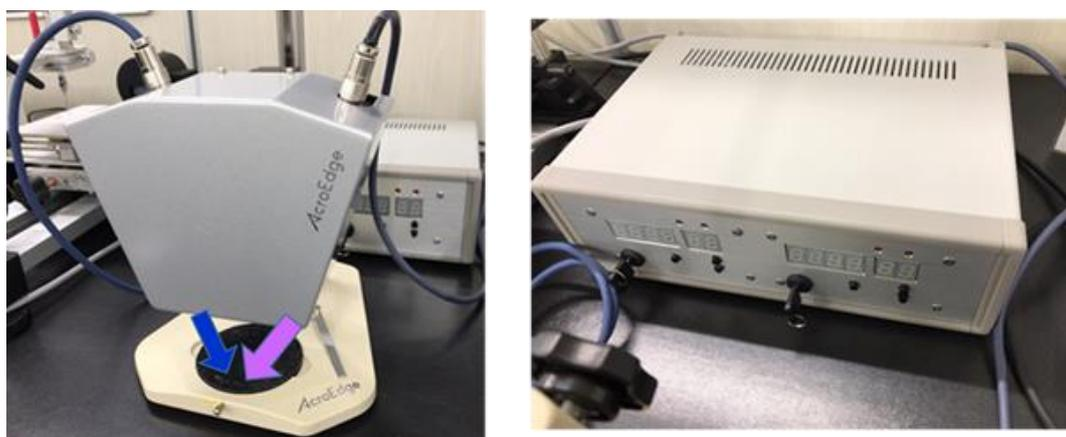
写真 2-3-1 ナノ粒子分散凝集定量測定装置
