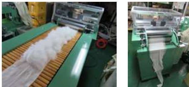
図-24 導入したニードルパンチングマシンを用いた実験の様子
