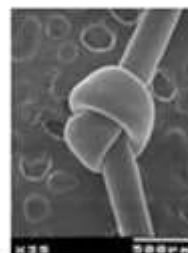
(a) POMモノフィラメント (b) POM/PLAアロイ繊維 図5 これまでに開発した POM 樹脂のフィラメント
