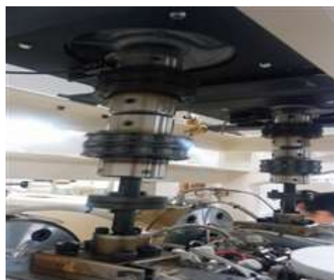
図-13 コアシエル型紡糸機とギアポンプ
