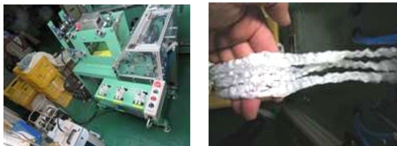
図-23 導入した捲縮機を用いた実験の様子
