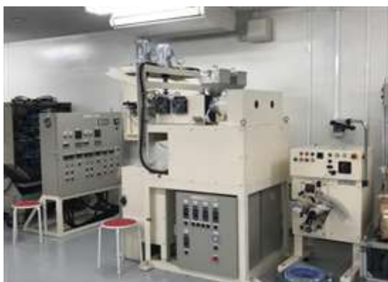
図-13 コアシエル型紡糸機とギアポンプ
