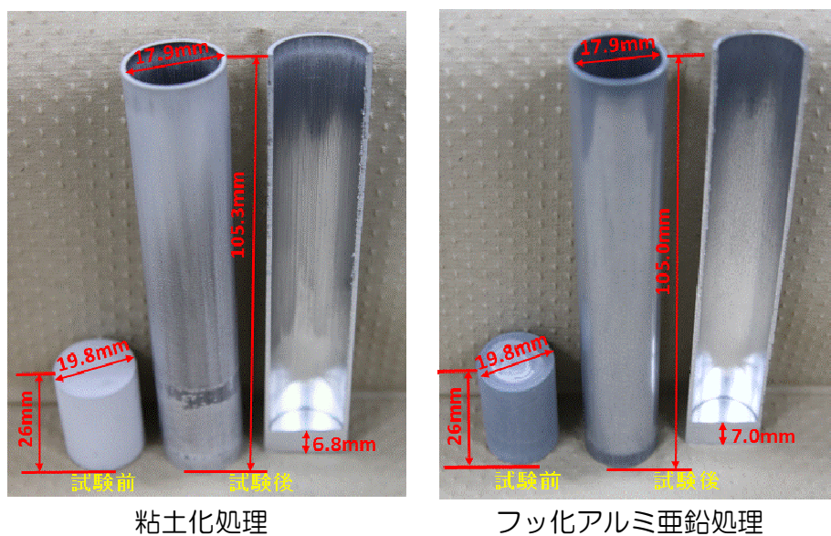
図18 加工倍率5倍の後方押し出し試験前後のビレット形状 (左から試験前、試験後、試験後の断面形状)
