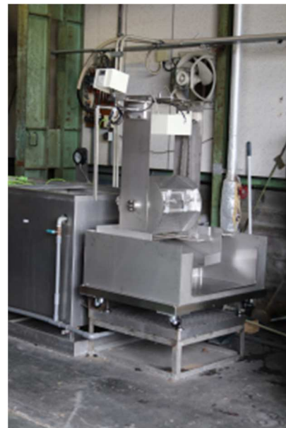
図14 小型バレル設備
