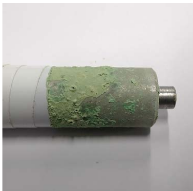
図 2.3.3 Ni 水酸化物が析出した状態
