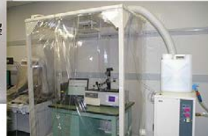
図 2.1.9 往復摺動方式の摩擦摩耗試験（低荷重タイプ）
