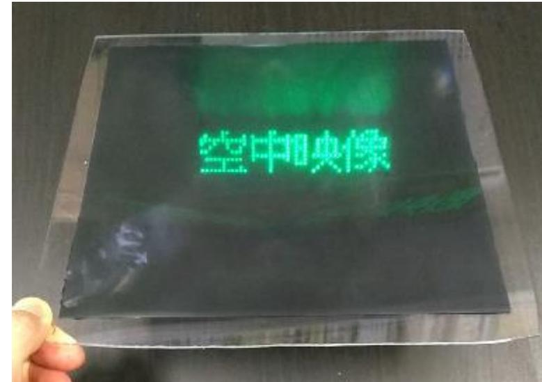
試作した200mm角サイズのDCRAにより表示した空中映像
