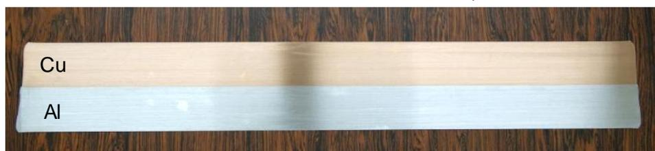
図 非混合FSW+圧延により作成したバイメタルシート
