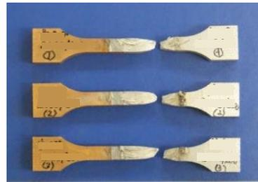
図 引張試験後の試験片外観
