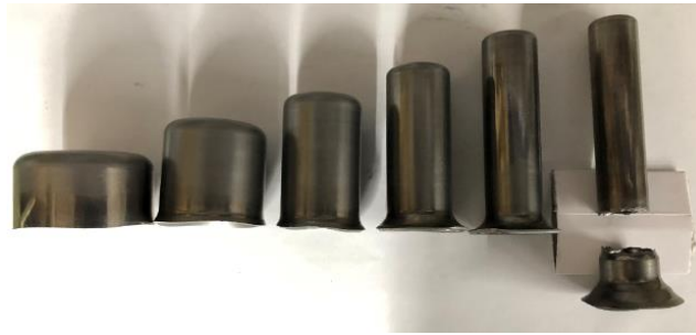
図2-6 コイル材料Aによるプレス成形加工実験結果（第7工程で破断）
