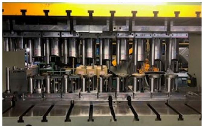
図2-4 リンクプレス機械に設置された金型全体図
