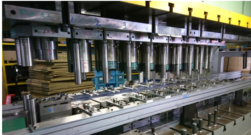
図3-4 連続生産によるプレス成形実験状況写真
