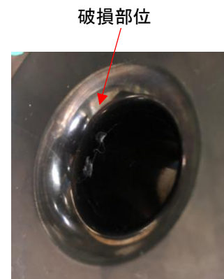
(c) 第8工程ダイス表面破損写真
