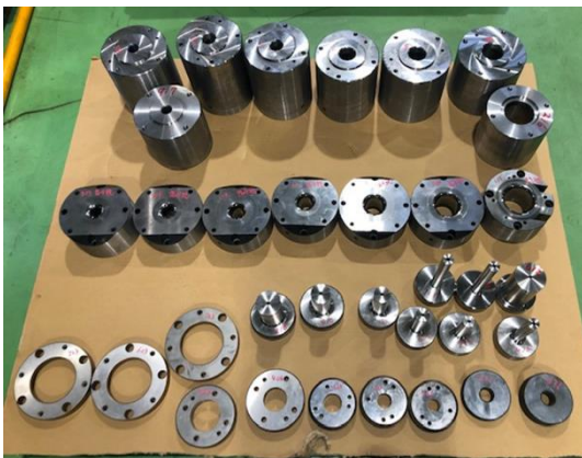
図2-3 プレス成形加工用金型構成部品
