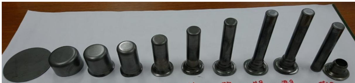
第1工程 第2工程 第3工程 第4工程 第5工程 第6工程 第7工程 第8工程 第9工程 （成形品）
