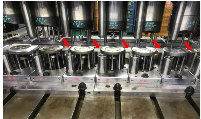
図3-3 ガイド(治具)を追加設置搬送調整
