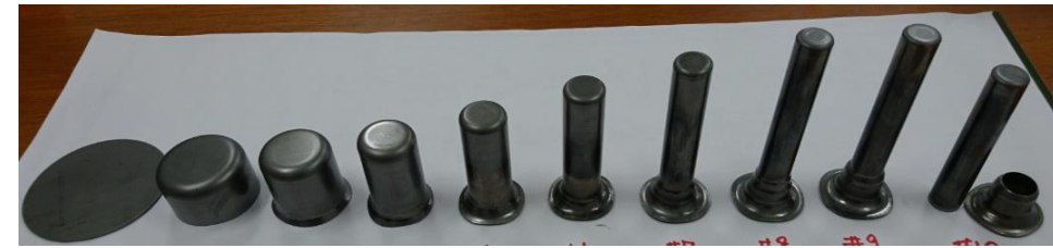
590kN高強度鋼板による超深絞り成形過程 (インフレーター部品)
