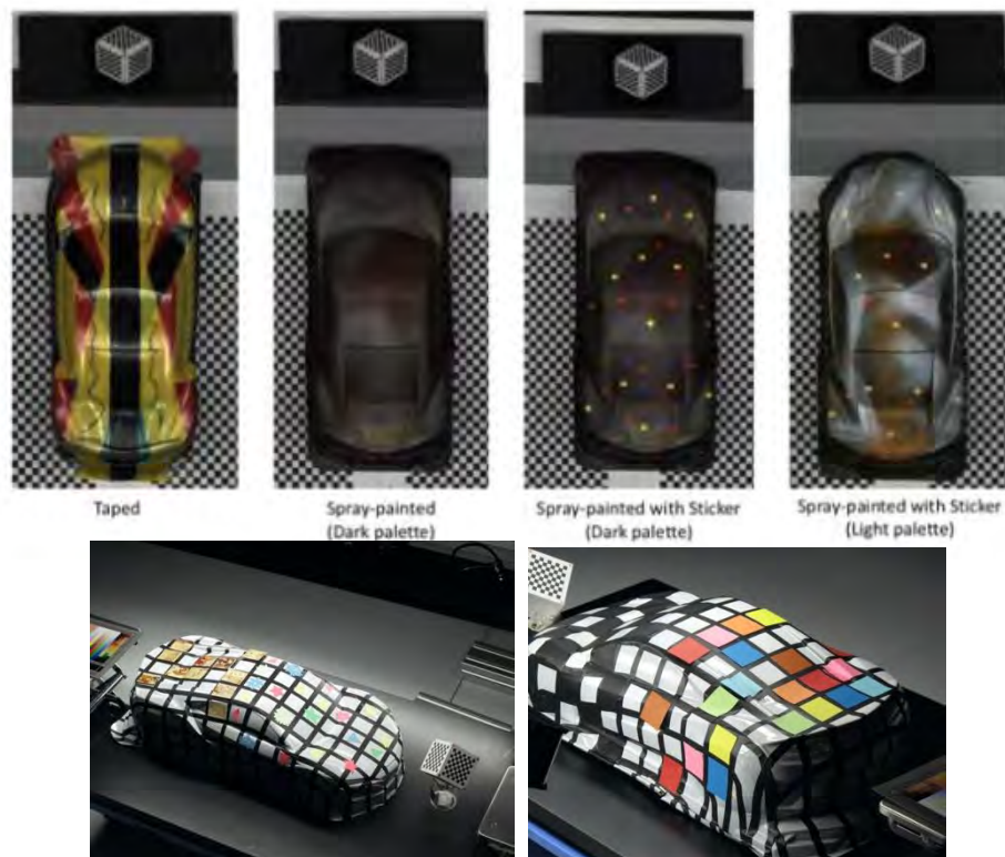
写真 11. 表面処理された模型と撮影画像
