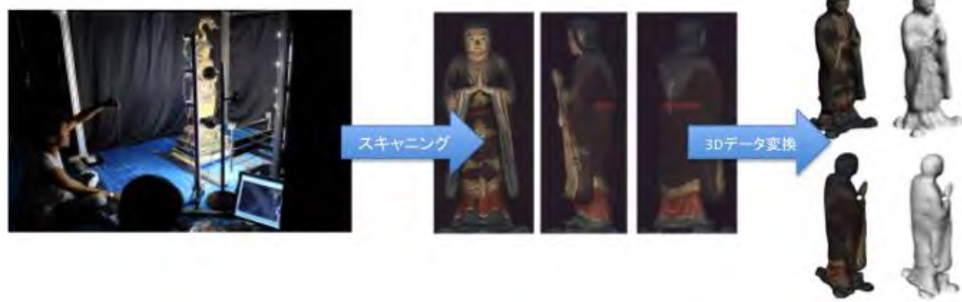
図 1. 3次元スキャニングの概要
