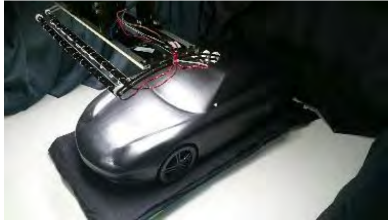
写真4. 1/4 モデルでのスキャンニング実験
