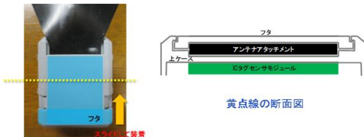
図 4 アンテナアタッチメント取付構造
