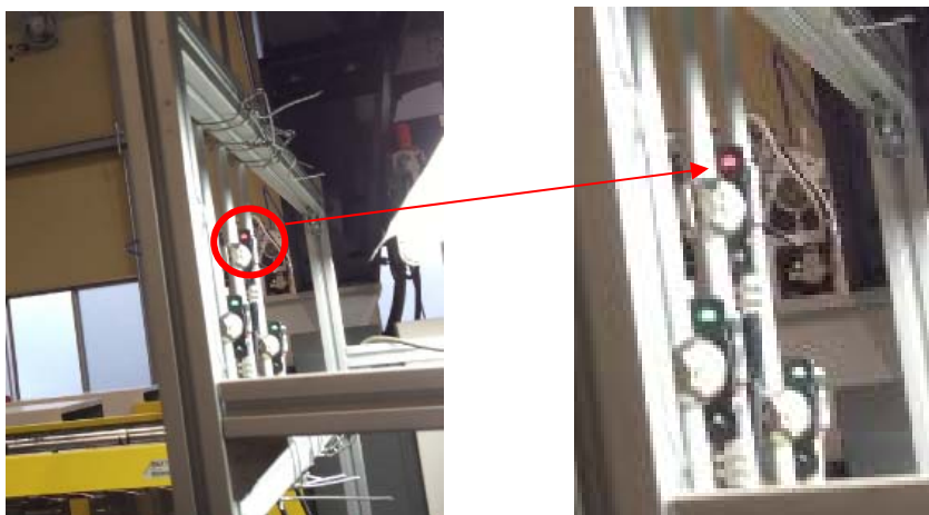
図18 NG判定時のカメラ付属のLED表示
