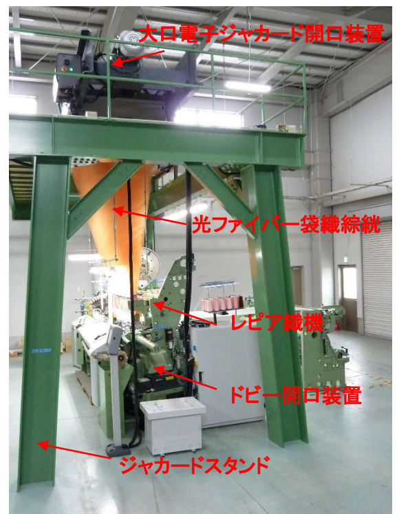
図 5. 特殊側面発光糸用複合開口システム搭載型レピア織機
