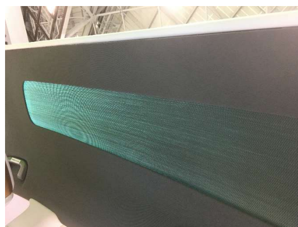
図 20. コンセプトカーの天井材に使用された発光ジャカード織物
