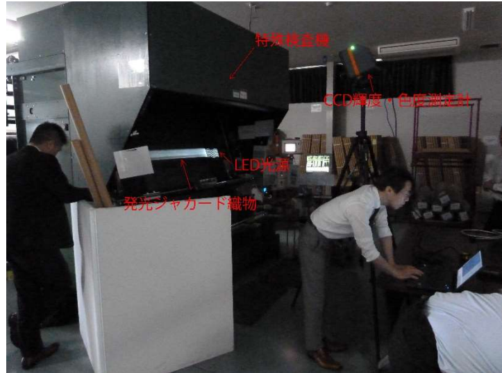
図 11. CCD 輝度・色度測定計搭載 発光ジャカード織物用特殊検査機
