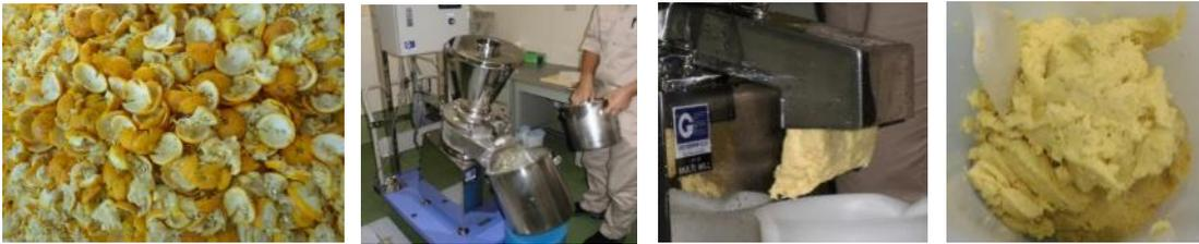
図 14 ユズ搾汁残渣 原料前処理装置 ペースト化処理 ユズペースト
