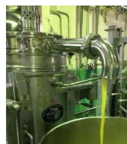
残渣分離装置
