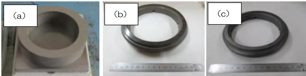
図2-3-6 回転リング試作品外観 (a) 成形体加工前 (b) 成形体加工後 (c) 焼成体
