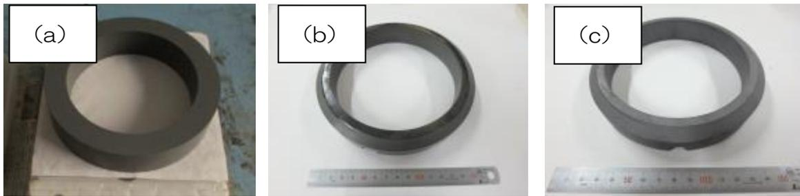
図2-3-5 固定リング試作品外観 (a) 成形体加工前 (b) 成形体加工後 (c) 焼成体
