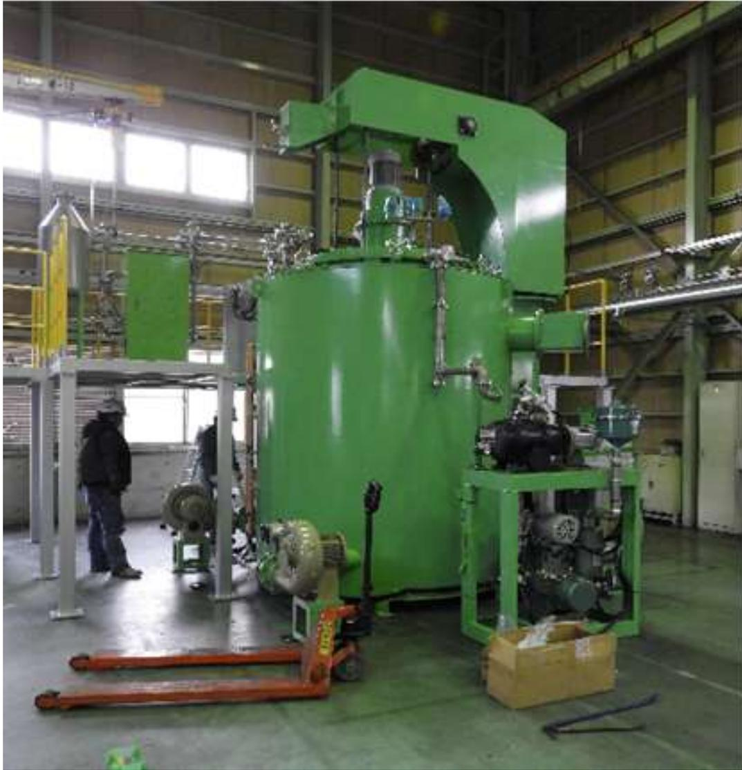
写真1 大型処理炉（ピット型スーパーマルチナイトプロセス装置）
