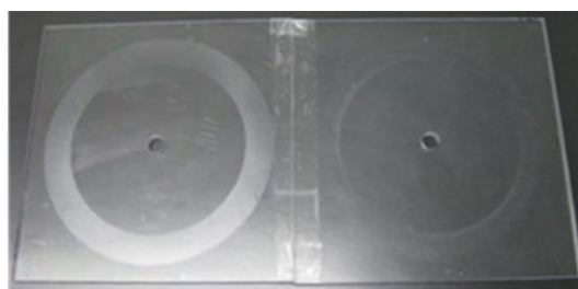
【写真 6】テーバー摩耗試験を実施した試験片の状態
