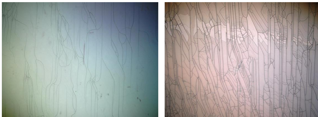
【写真 3】スーパーキセノンウェザー促進耐候性試験でハードコートに発生した劣化状態
