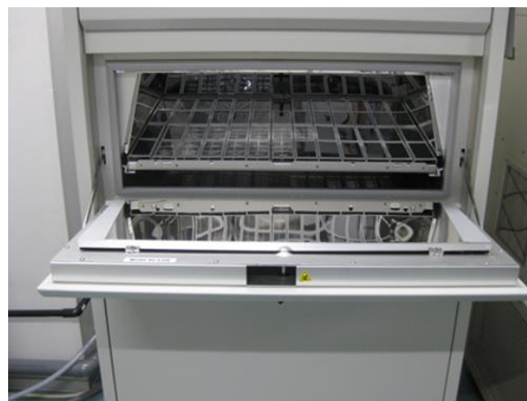
【写真 4】 Q-SUN キセノン促進耐候性試験機内の試験片の取り付け状態
