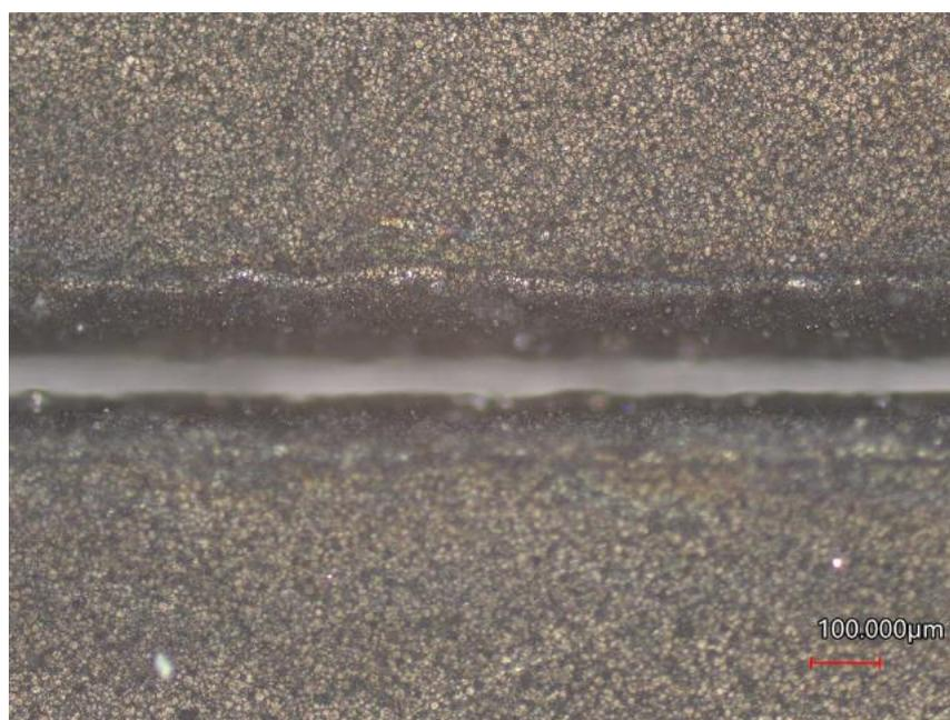
図2.35. ファイバーレーザーによる切断（熱加工）
