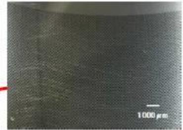
図1. 8 エンジンシリンダボアのディンプル加工
