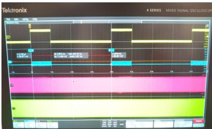
図2. 57 オシロスコープによるレーザ照射タイミングの計測
