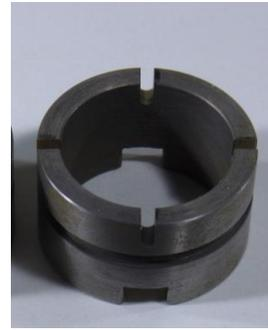
図2. 44 摩擦試験用リング
