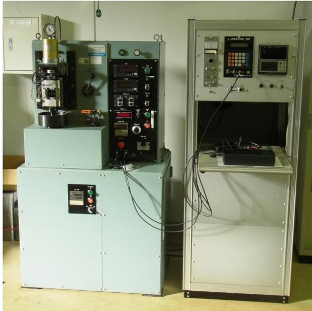
図2.41 摩擦試験器及びデータログ
