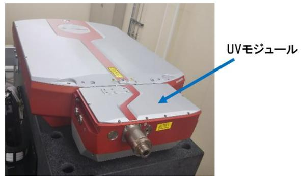
図2. 6 発振器へのUVモジュール取付
