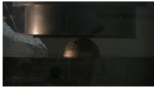
図24 純チタン積層造形材の寛骨臼の圧縮試験（横方向、変位-荷重図）と試験の様子
