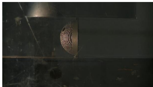
図25 純チタン積層造形材の寛骨臼の圧縮試験（縦方向、変位-荷重図）と試験の様子
