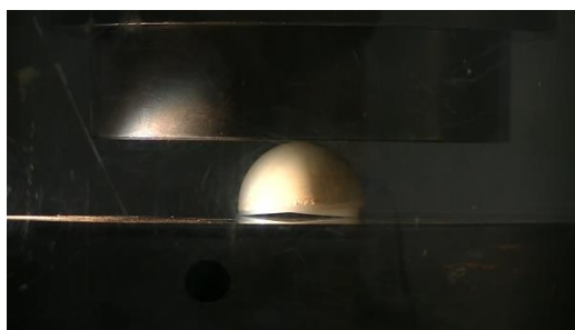
図26 骨セメント材の寛骨臼の圧縮試験（横方向、変位-荷重図）と試験の様子
