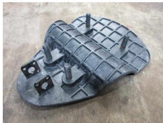
図 2-3-13 ステアリングサポート（CFRTP 製）
