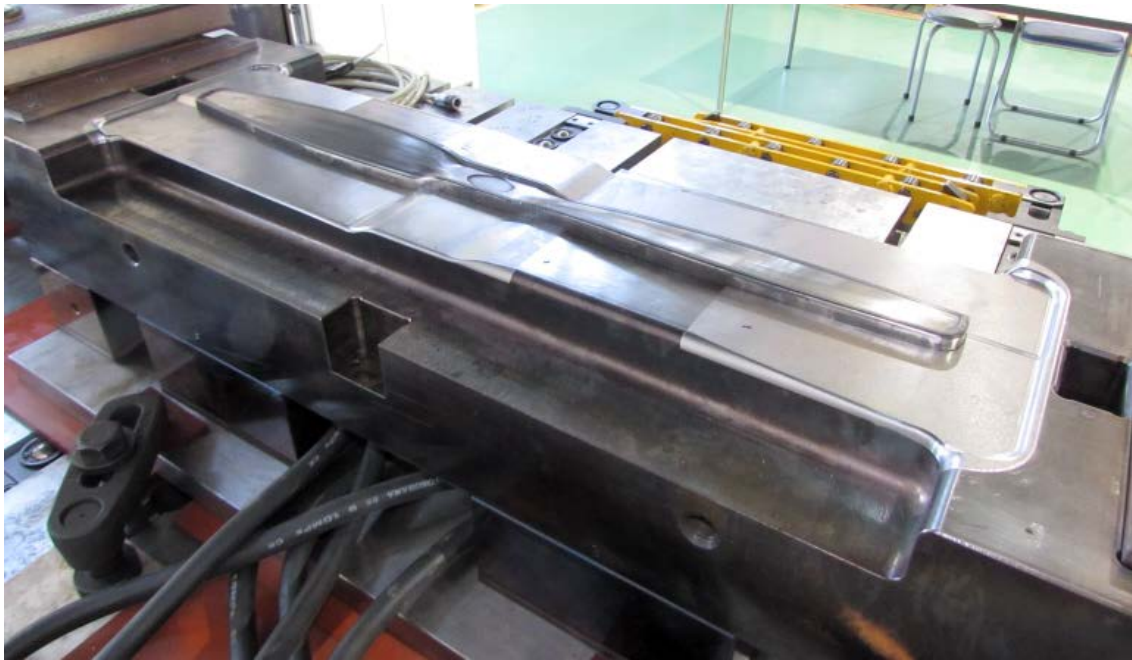
図 2-3-4 プロペラ成形金型（図 2-2-12 の（3）の状態）
