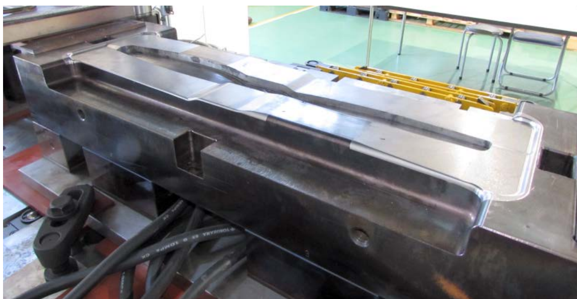
図 2-3-3 プロペラ成形金型（図 2-2-12 の（2）の状態）
