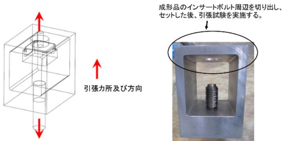
図 2-3-21 引張試験治具
