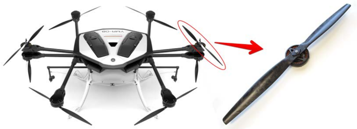
図 2-3-1 農薬散布用無人航空機とそのプロペラ（直径 26 インチ(660mm)）
