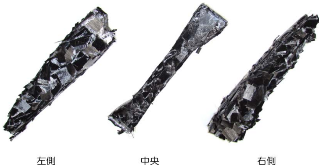
図 2-3-2 3 分割して準備したプロペラの成形材料
