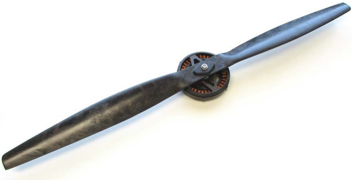
図 2-3-5 モーターに取り付けた試作品のプロペラ
